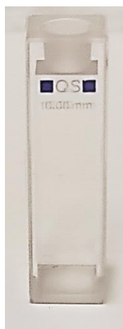
14. irudia: zinetikak neurtzeko erabilitako kuartzozko kubeta.
