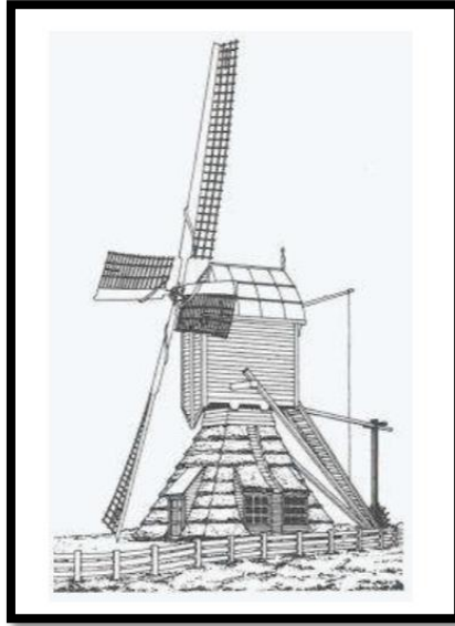
Figura 12. Molino holandés tipo trípode para bombear agua y moler (siglo XVI). 11
