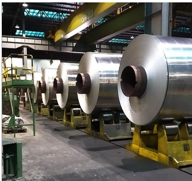
Ilustración 61: Paletas LF6 sobre el carril de rodillos
