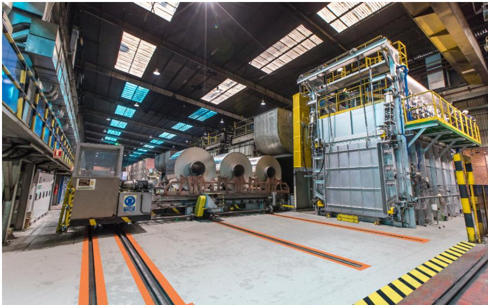
Ilustración 63: Horno de recocido (HR) y mesa cargadora introduciendo bobinas en cámara de enfriamiento
