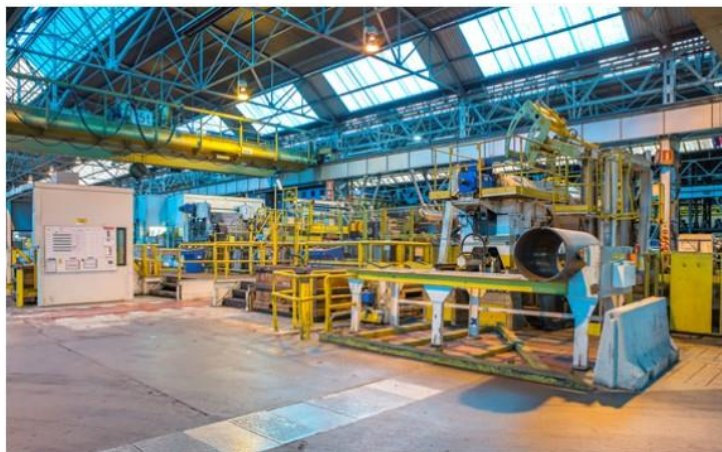
Ilustración 44: Línea de corte de chapas (CA4)
