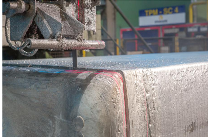
Ilustración 32: Sierra de placas (SC4) cortando pie o bebedero de placa
