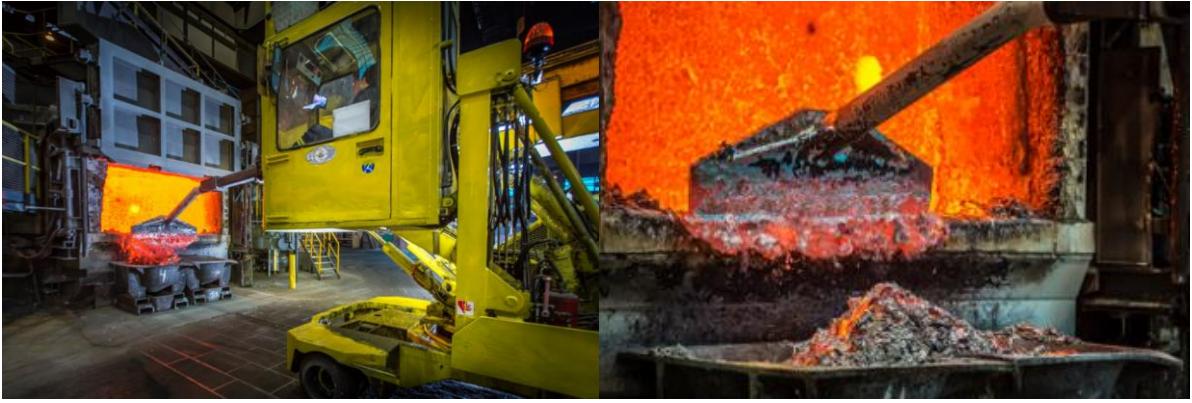
Ilustración 28: Extracción de escorias de la colada para su reciclaje
