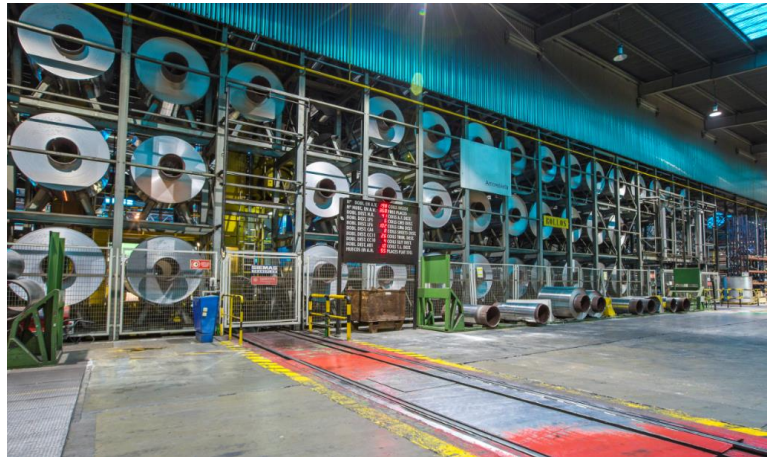
Ilustración 42: Almacén vertical de bobinas (AV)
