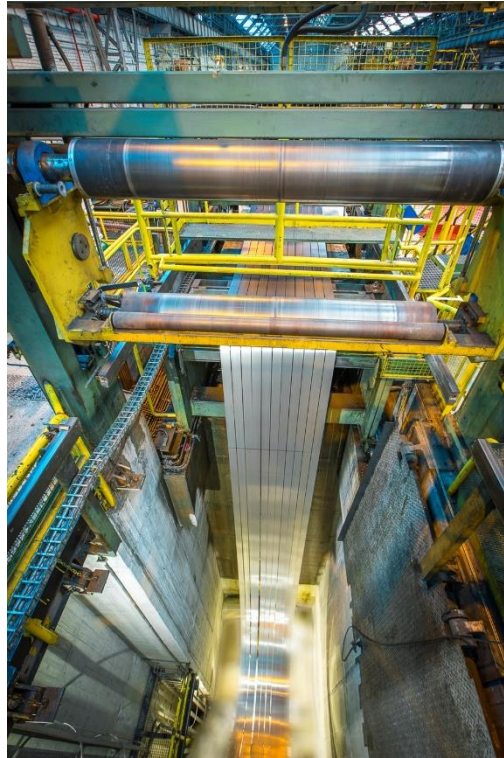
Ilustración 43: Línea de corte longitudinal (CC11)
