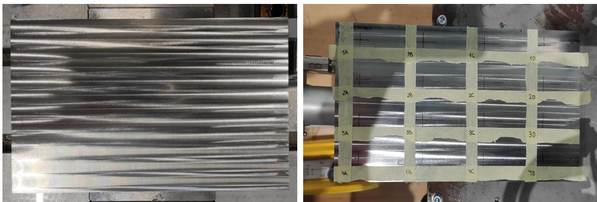
Ilustración 60. Preparación de la probeta mecanizada para obtener las tensiones residuales del modelo.
