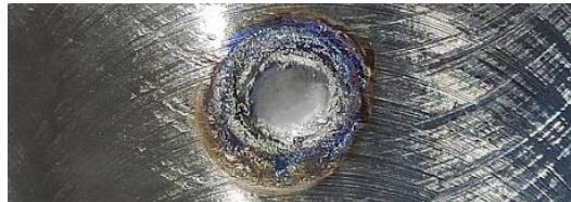
Ilustración 44. Huella generada tras un electropulido a 0,12 mm de profundidad.
