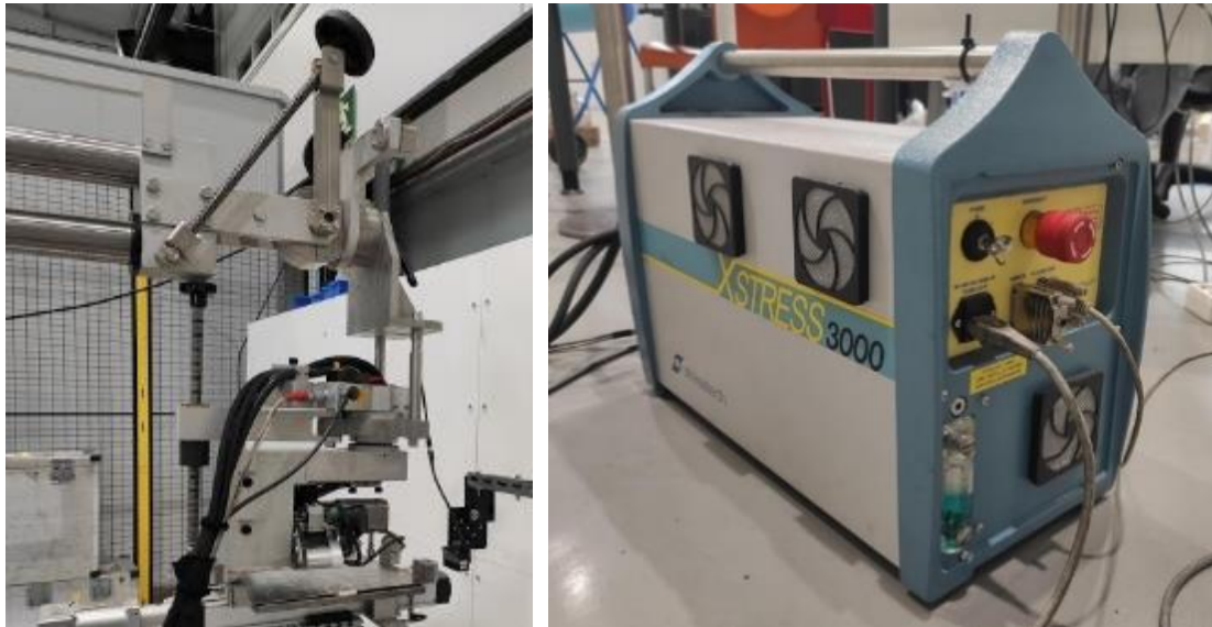
Ilustración 38. Goniómetro (izq.) y unidad principal (drcha.) del difractómetro de Rayos-X Xstress 3000.
