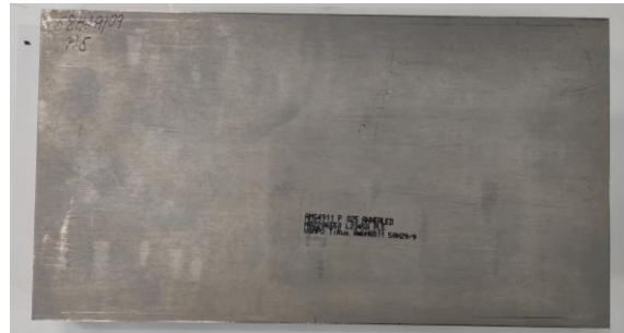
Ilustración 28. Probeta de la aleación de titanio Ti6Al4V sometida a estudio.
