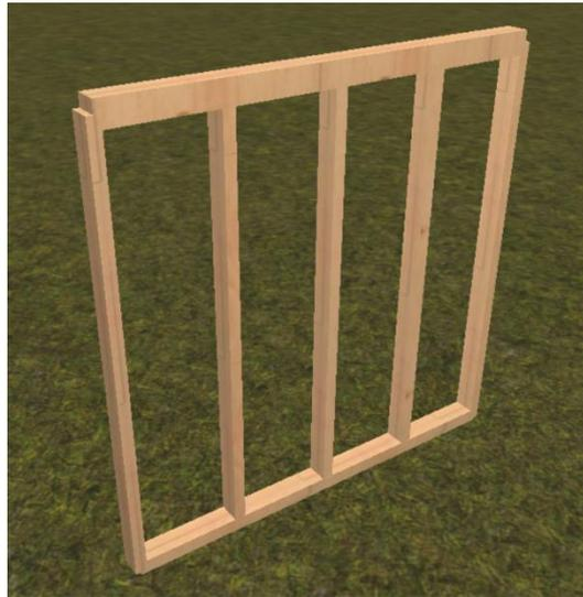
Figura 6.7. Representación 3D del modelo de CYPE para panel de fachada
