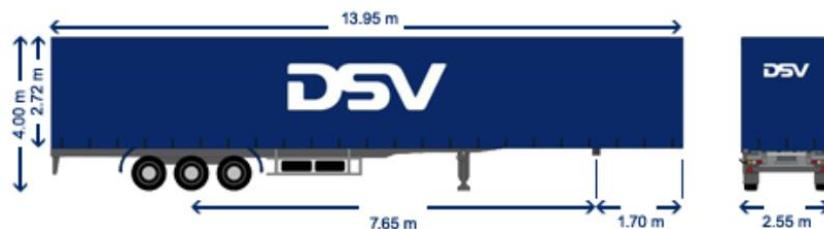
Figura 2.1. Dimensiones tráiler tauliner. Fuente: DSV
