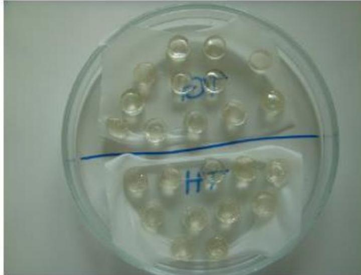
Figura 6: Pruebas de hinchamiento realizadas a xerogeles (E. Orozo-Guareño, 2011).
