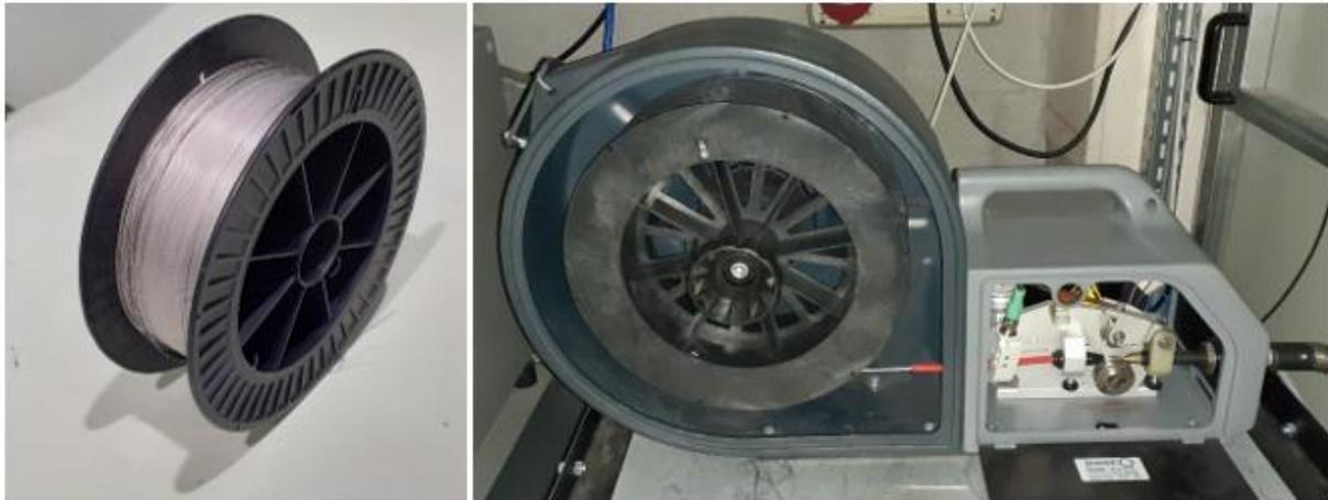
Figura 107: Bobina de  $Ti_6Al_4V$  (Izq.) y su montaje en el alimentador de hilo (Drcha.).
