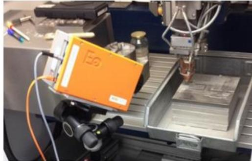
Figura 100: Disposición de cámara IR off-axis fuera de la zona de trabajo empleado por Hassler et al. [78].
