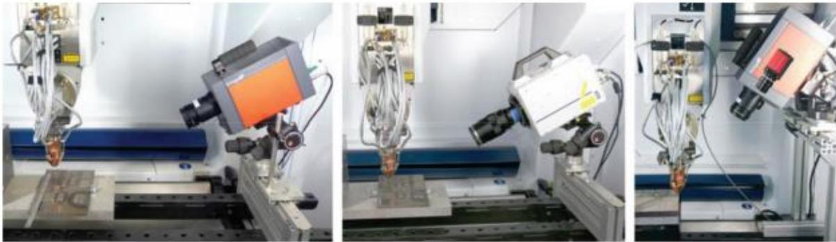
Figura 98: Cámara MWIR a 60° (Izq.), cámara de visión a 60° (central) y cámara SWIR a 40° [45].
