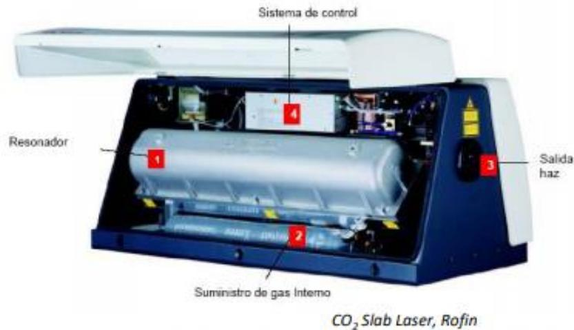
Figura 9: Construcción de los láseres de CO<sub>2</sub> [13].
