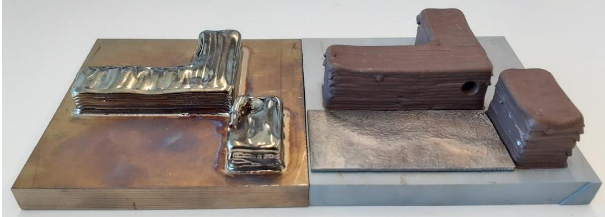
*Figura 135: Oxidación de la pieza al extraer del horno a 700°C (Izq.) y 900°C (Drcha.).*
