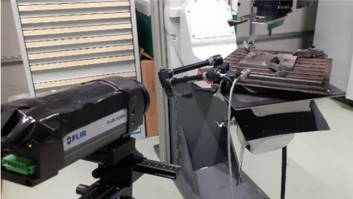
*Figura 104: Adquisición a 90° tanto del pirómetro IMPAC IGAR 12-LO MB 22® como la cámara FLIR A325 G® para la determinación de ciclos de calentamiento y enfriamiento de piezas de  $Ti_4Al_6V$  fabricados mediante LMD-w.*
