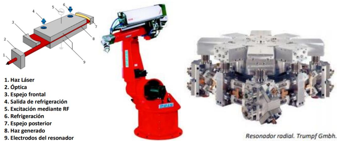
Figura 11: Construcción de los láseres de CO<sub>2</sub> tipo *Slab* (Izq.), sellada (centro) y de flujo radial de Trumph GmbH (Drcha.) [13].
