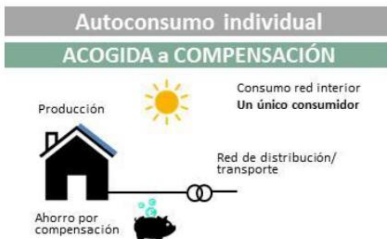
Figura 6. Autoconsumo individual con excedentes acogido a compensación [20]
