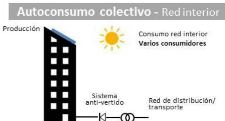
Figura 5. Autoconsumo colectivo sin excedentes [20]
