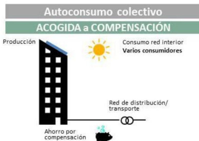
Figura 7. Autoconsumo colectivo con excedentes acogido a compensación [20]
