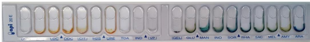
**Figura 2:** Prueba API 20C Aux (Biomerieux, Ref: 20 210). Donde se realizaron las pruebas de lisina descarboxilasa, sulfito reductasa; ureasa, indol y β-glucosidasa.
