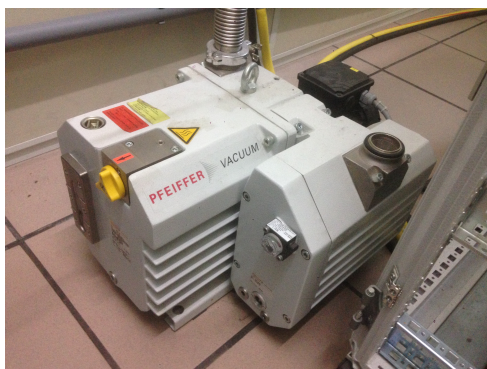
Figura 19: Bomba de apoyo DUO 35 [15]
