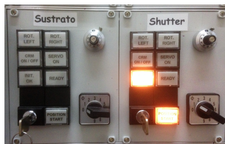
Figura 28: Controlador de motores del sustrato y shutter
