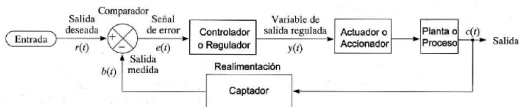
Figura 32: Diagrama de bloques del sistema. [20]
