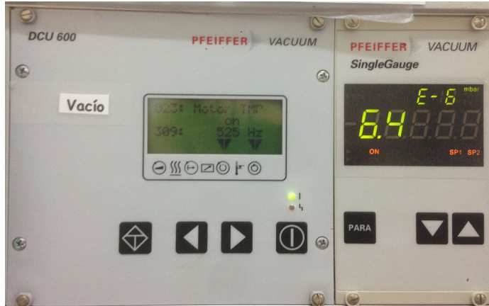
Figura 23: Parte frontal de la unidad de control ( Single Gauge TPG 261 ). [1]
