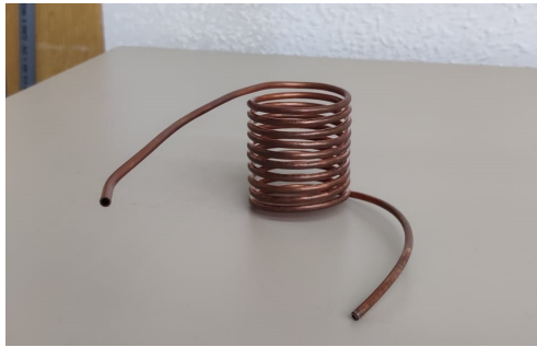
Figura 3.2: Bobina hecha de tubo de cobre de 4mm de diámetro exterior.
