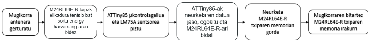
Irudia 16: NFT teknologia implementatzeko diseinatutako zirkuituaren fluxu-diagrama.
