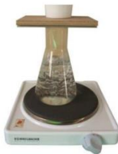
Figura 16. Esquema del montaje de ensayo de resistencia al vapor de agua (ENSATEC, 2014).
