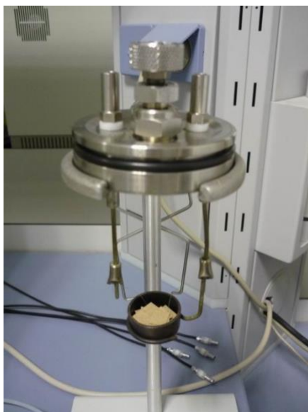
Figura 12. Montaje de la muestra y equipo de Bomba Calorimétrica.
