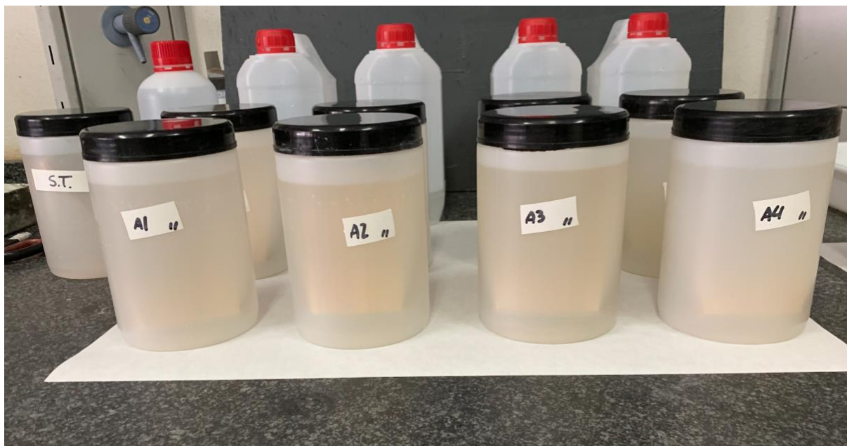
Figura 4. Proceso de inmersión ignifugante a pequeña escala.
