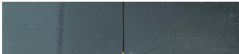
Figura 32. Resistencia al rayado del barniz A4009 (izquierda) y A4009-PH6 10%wt. (derecha).
