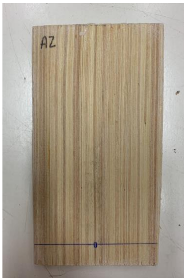
Figura 6. Preparación de las probetas de madera para el ensayo de pequeño quemador.
