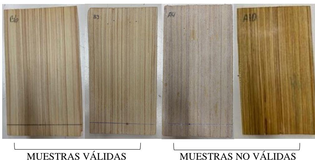
Figura 9. Ejemplos de probetas válidas y no válidas.
