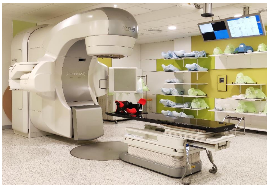
Figura 2. Acelerador lineal TrueBeam (Varian®) del HUB. Este acelerador lineal permite administrar la SBRT con la técnica VMAT.
