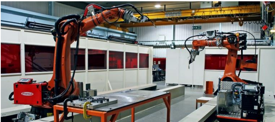
Figura II-21. Célula robótica de WAAM basado en GMAW con 2 robots trabajando en paralelo, para aumentar la productividad [WAAMMAT, 2021]
