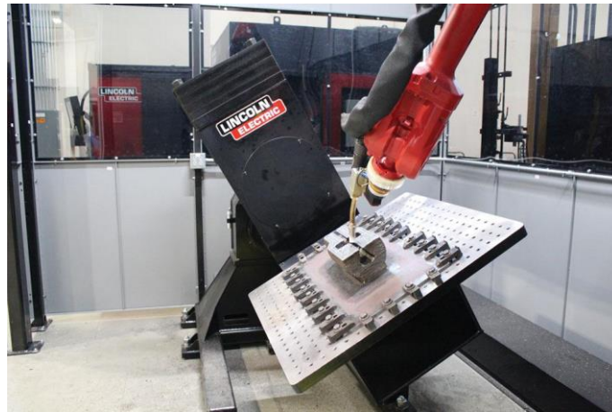
Figura II-19. Solución basada en un robot antropomórfico de la empresa Lincoln Electric [Lincoln Electric Additive, 2021]
