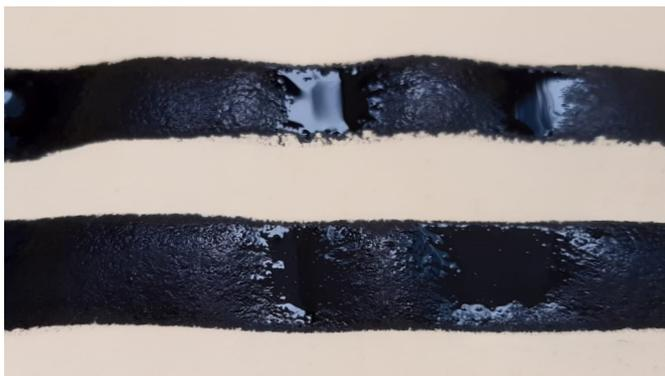
Figura 32. Fotografía donde se observa la poca capacidad del P2 de absorber medios acuosos
