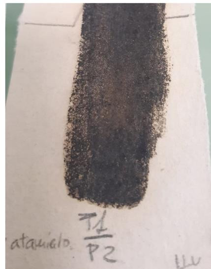
Figura 33. Fotografía donde se observa como se han desprendido zonas de la tinta en la probeta T1/P2 (+T) del grupo ILU
