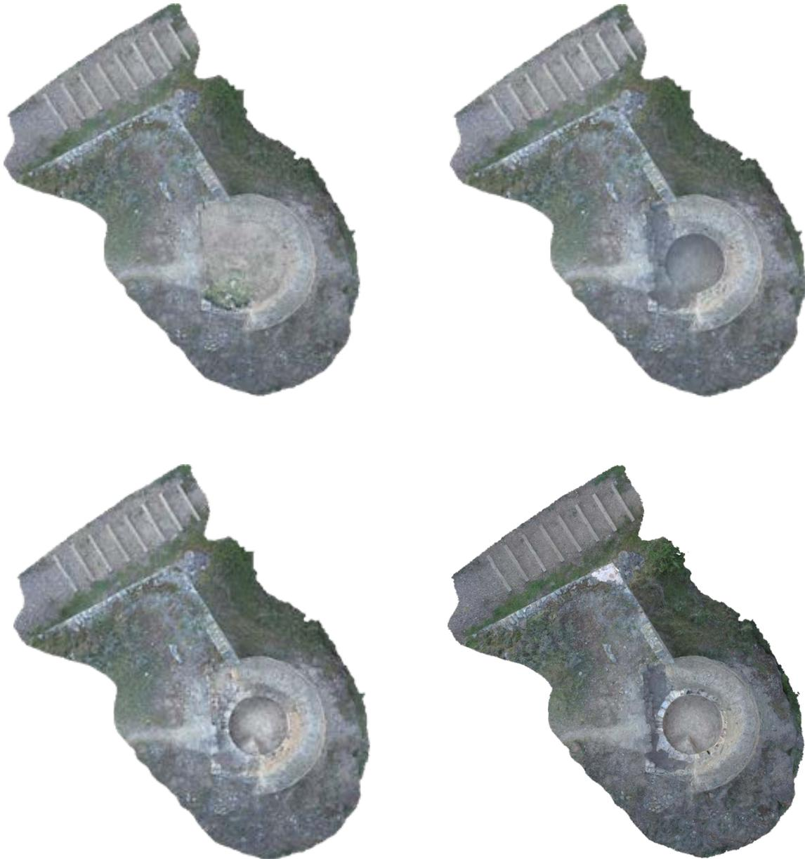
Fig. 19. Serie de ortoimágenes que contiene cada una de las fases de evolución de la excavación arqueológica y de la restitución de la mampostería de la esquina norte. Escala aproximada 1:250
