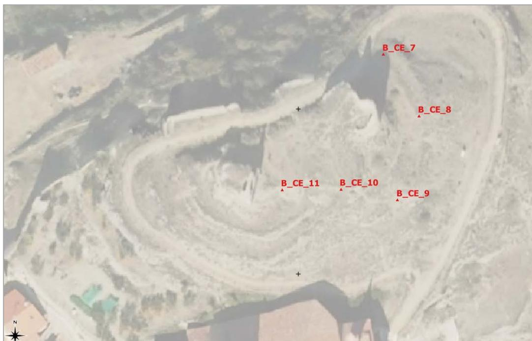
Fig. 9. Distribución de los clavos utilizados como red de referencia sobre la ortoimagen de planta de la muralla Norte del castillo de Enciso.
