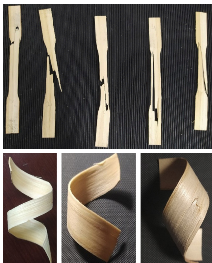
Fig. D04. Ejemplo de rotura de algunas probetas del sistema
