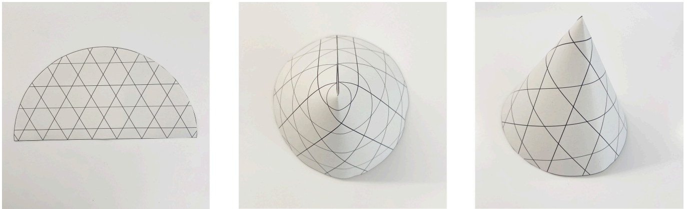
Fig. E12. Desarrollo en papel de la superficie del cono de sector 180^\circ con trama kagome dibujada
