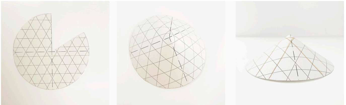
Fig. E52. Modelo en papel del cono de sector 300° con trama kagome dibujada
