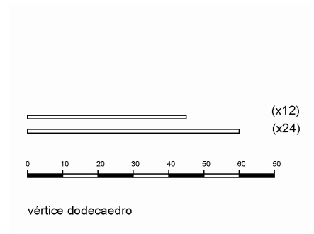
Fig. E40. Esquema de número de cintas y longitud necesarias para la confección
