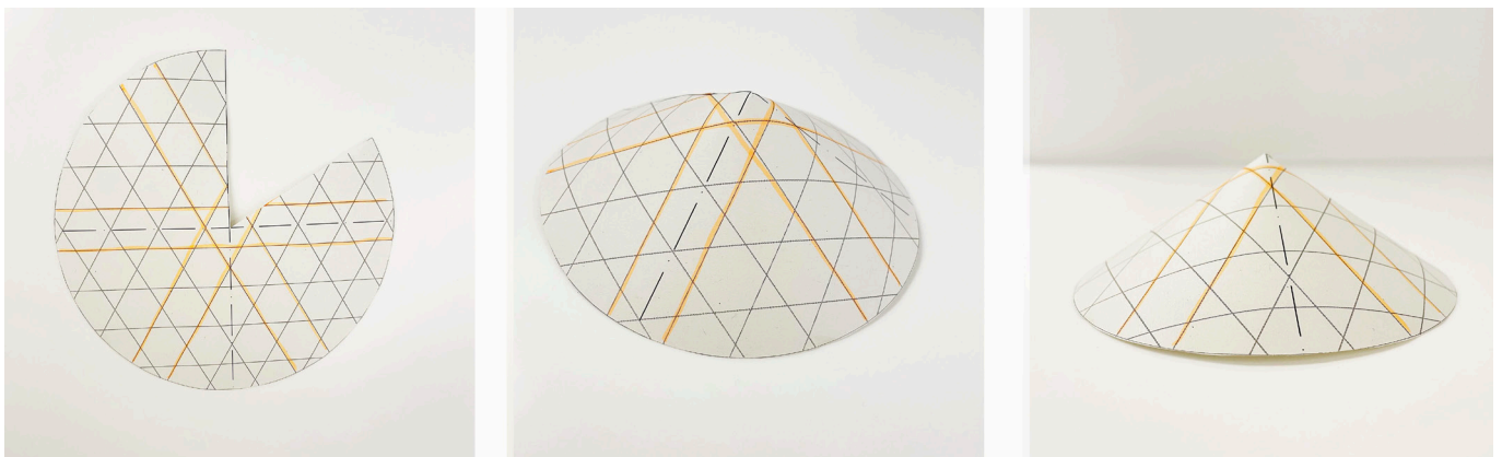
Fig. E53. Análisis de líneas geodésicas en modelo de papel de cono de sector 300°
