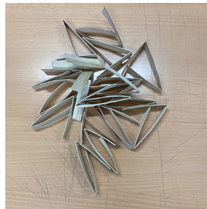
Fig. E66. Grapas de unión realizadas con TPMC
