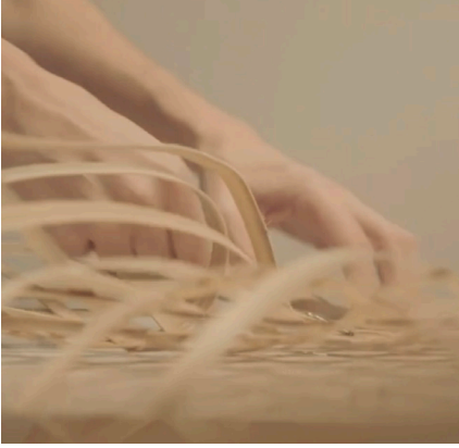
Fig. 01. Proceso de entretrejer con tira plana de madera de castaño (foto: Javier Agirre Erauso)
