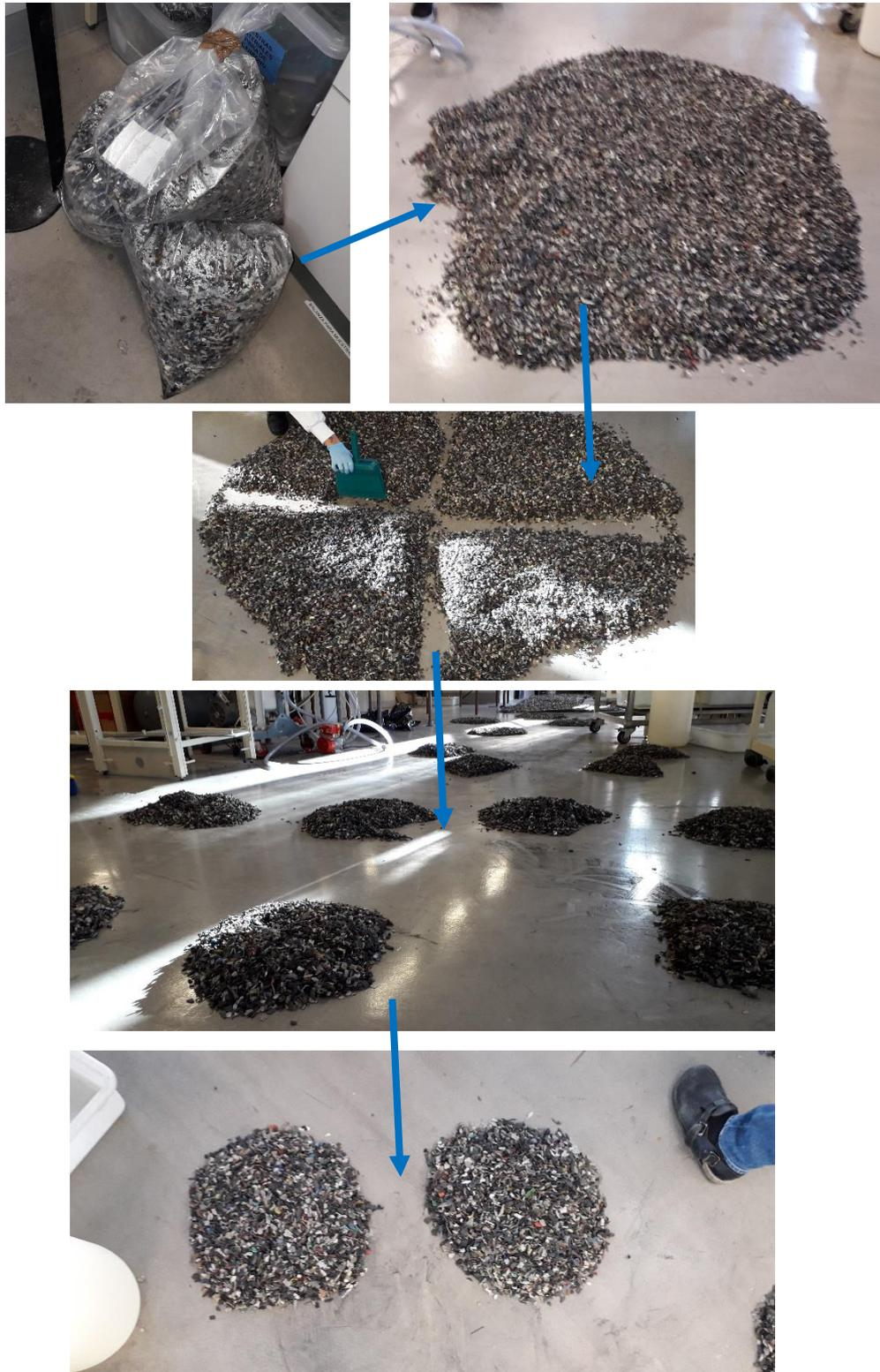
Figura 7. Proceso de cuarteo y realización de muestras de 100 g
