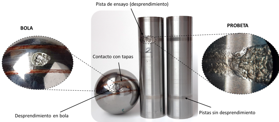
Figura 5.17: Probetas y bola tras ensayo RCF. Se muestran detalles de desprendimientos en bola (izquierda) y pista de ensayo (derecha).
