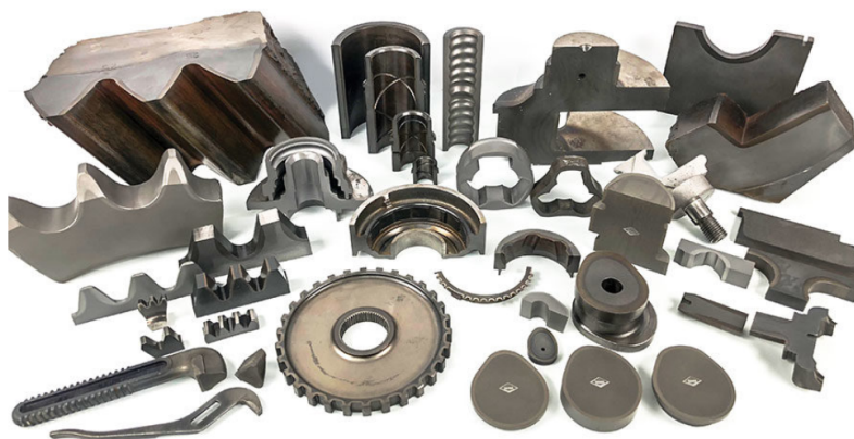
Figura 1.2: Componentes típicamente templados por inducción (Lynch, 2019).
