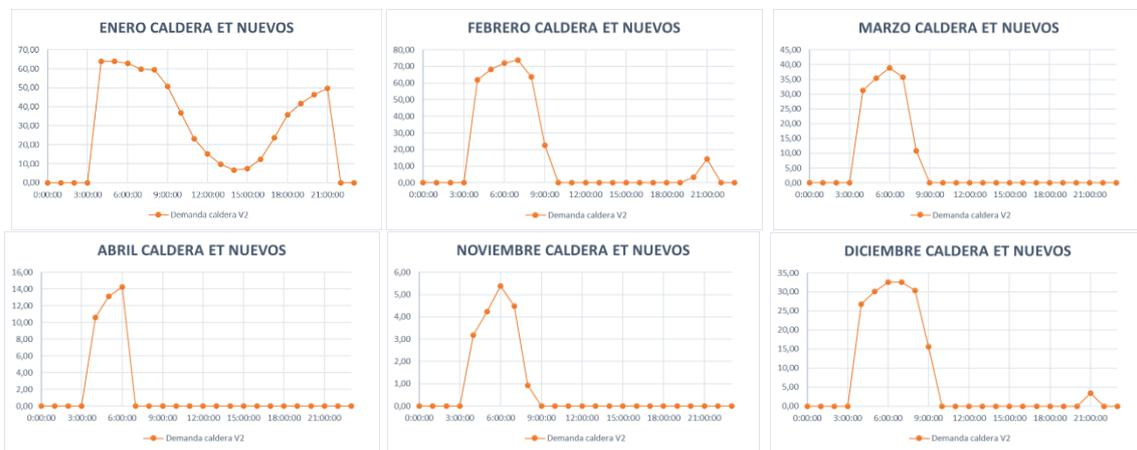
Figura 6.19. Demanda térmica cubierta por las calderas con elementos terminales nuevos
