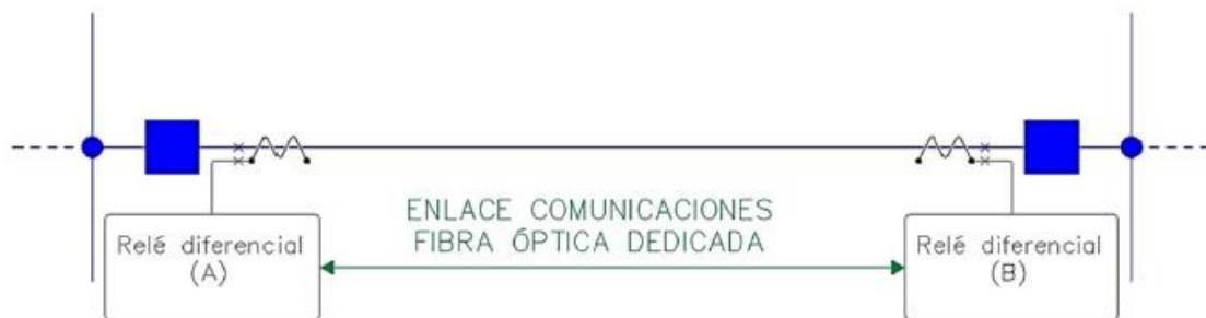
Figura 3. Esquema protección diferencial
