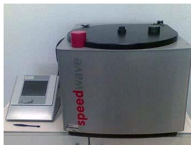
Fig.2.9. Microondas Berghof para digestión
