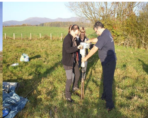
Fig.2.2. Sondeo mecánico de percusión
