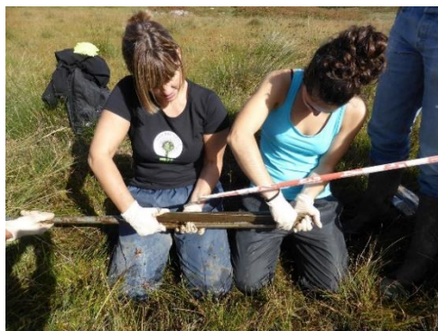
Fig.2.3. Extracción de testigo en sonda manual
