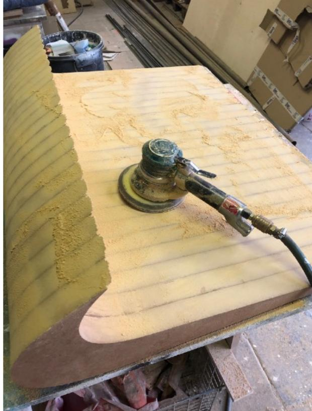
Imagen del proceso de trabajo. Lijado de la pieza.
