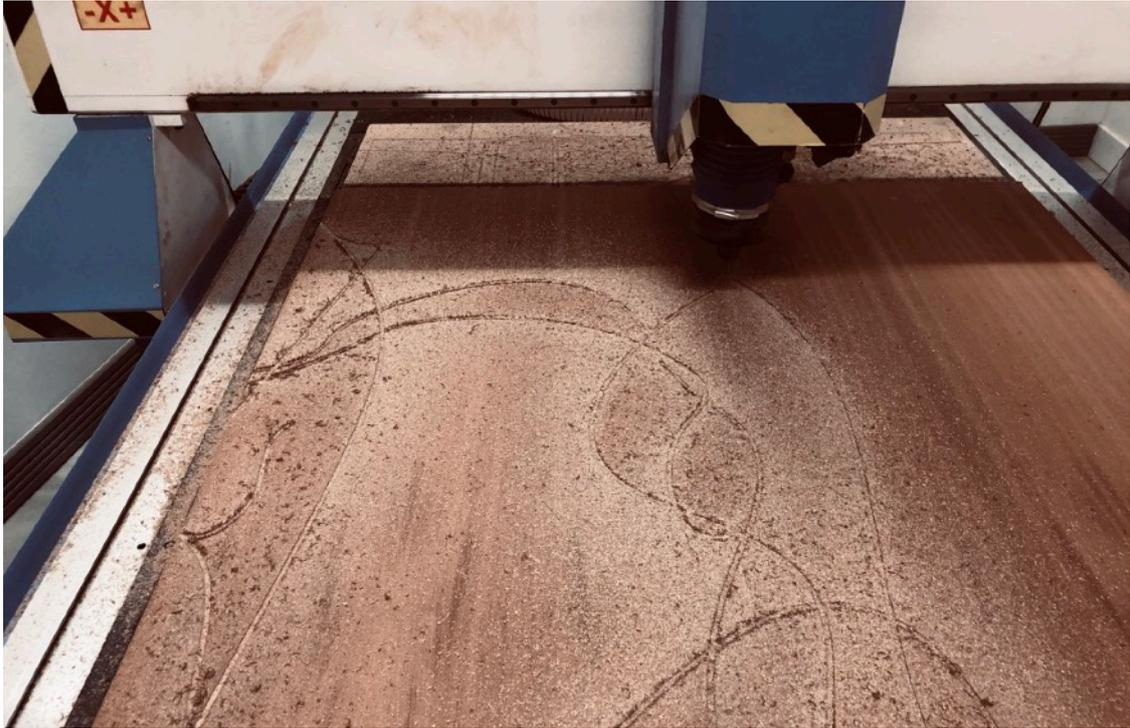
Imagen del proceso de trabajo. Grabado de los tableros en la maquina CNC
