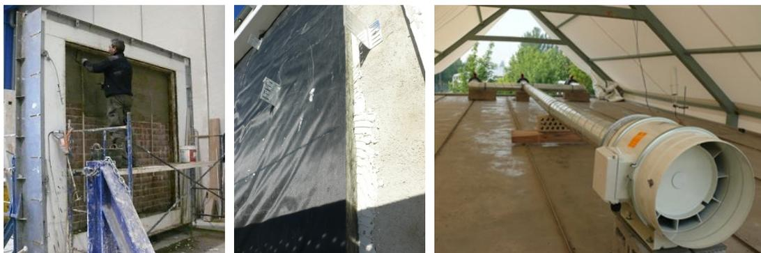
**Figura 2.21** – Dos etapas del proceso de fabricación de la muestra y aspecto del sistema de extracción de aire de cámara instalado sobre la célula de ensayo
