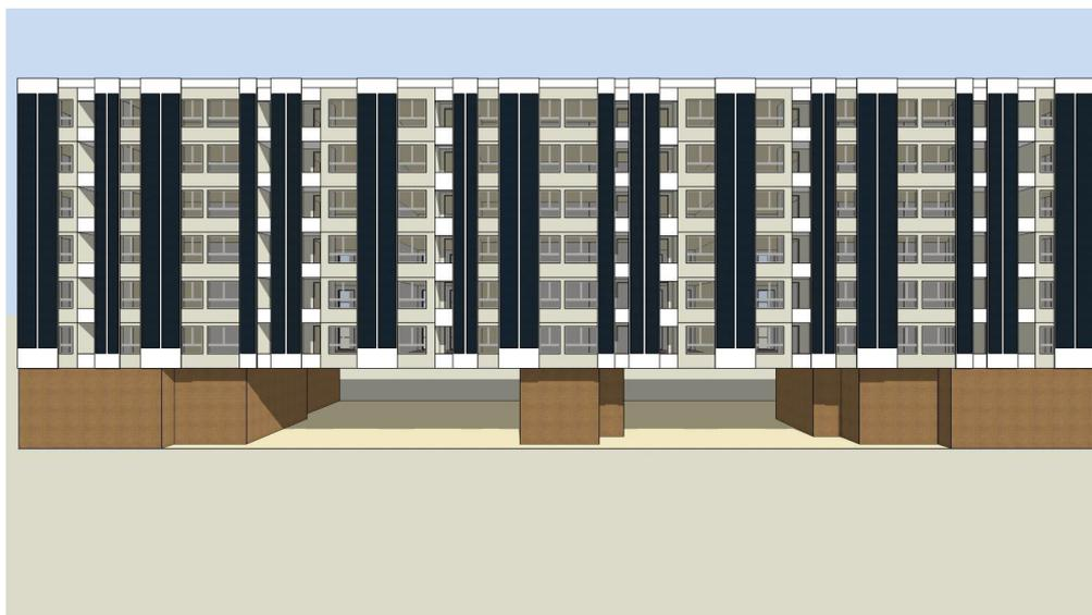
*Figura 4.28 –Aspecto del modelo de edificio incorporando tramos de fachada FVFF en la cara sur*
