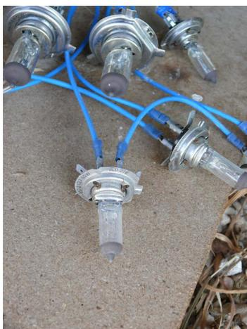
**Figura 2.44** – Bombillas empleadas para la disipación de la energía producida por la fachada FVFF.
