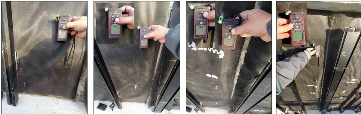
Figura 2.30 – Altura de los sensores en cámara respecto a la cota de entrada de aire: 0,6; 1,2; 1,8 y 2,4 m
