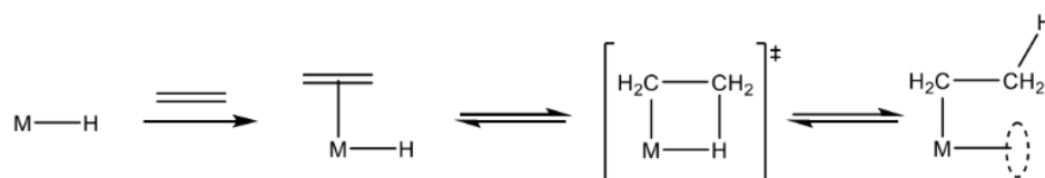
Esquema 2.3: inserción de una olefina en el enlace metal-hidruro.
