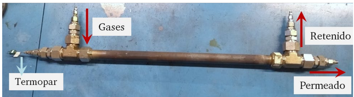
Figura 12A'. Pasos del montaje del reactor de membrana R+M y COM.
