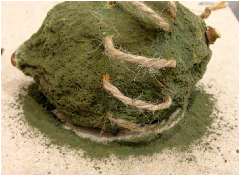
[F. 84] Detalle de migración de Penicillium digitatum . Probeta INNESTI (2017). Foto: Haizea Salazar Basañez
