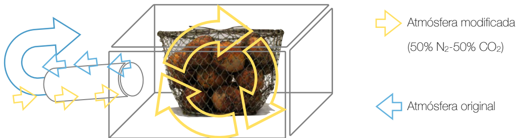
[F. 96] Esquema de la instalación de la nueva atmósfera en el contenedor que almacena la obra.
