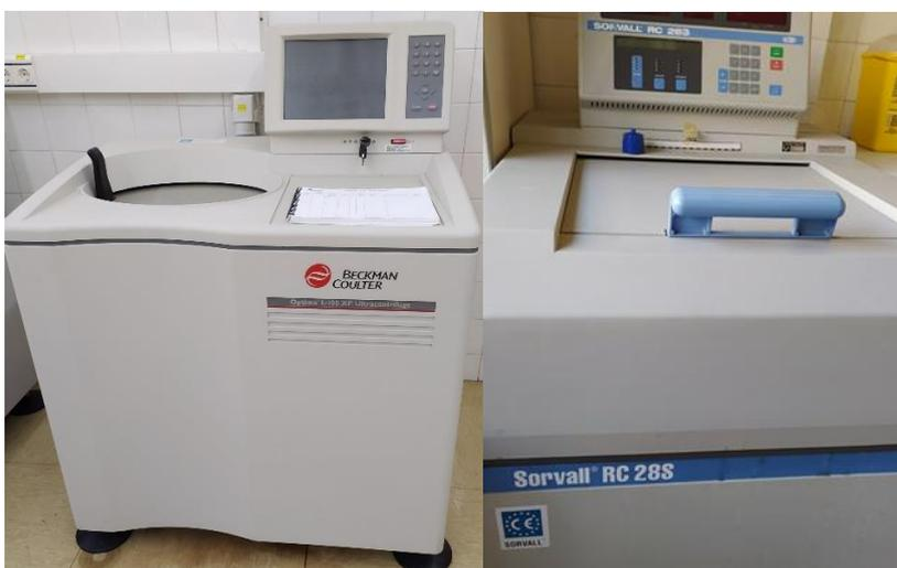
**Figura 41.- Ultracentrifugadora OPTIMA L-100 XP de Beckman Coulter y Centrifugadora Sorvall RC 28S de Du Pont.**
