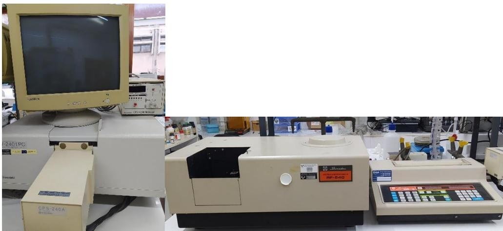
**Figura 40.- Espectrofotómetro UV-2401 P de Shimadzu y Espectrofluorímetro RF 540, también de Shimadzu.**
