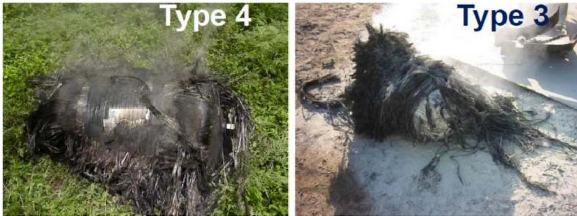
**Ilustración 8-14 Fragmentos de los tanques después de la explosión. Fuente[39]**
