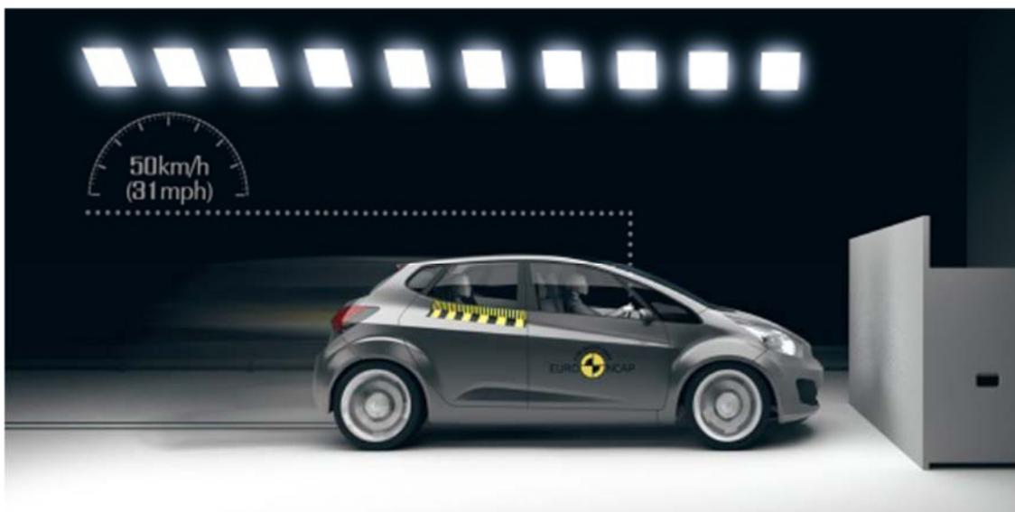
**Ilustración 8-3 Ensayo de colisión frontal con barrera fija. Fuente [35]**
