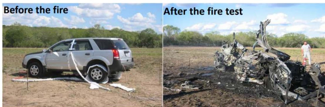
*Ilustración 8-12 Antes y después de la explosión del tanque Tipo III. Fuente [39]*
