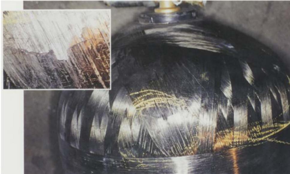
**Ilustración 8-8** Agrietamiento de la fibra del material compuesto indicativo de impacto. El daño puede ser mayor debajo de la superficie y no visible. Fuente [37]
