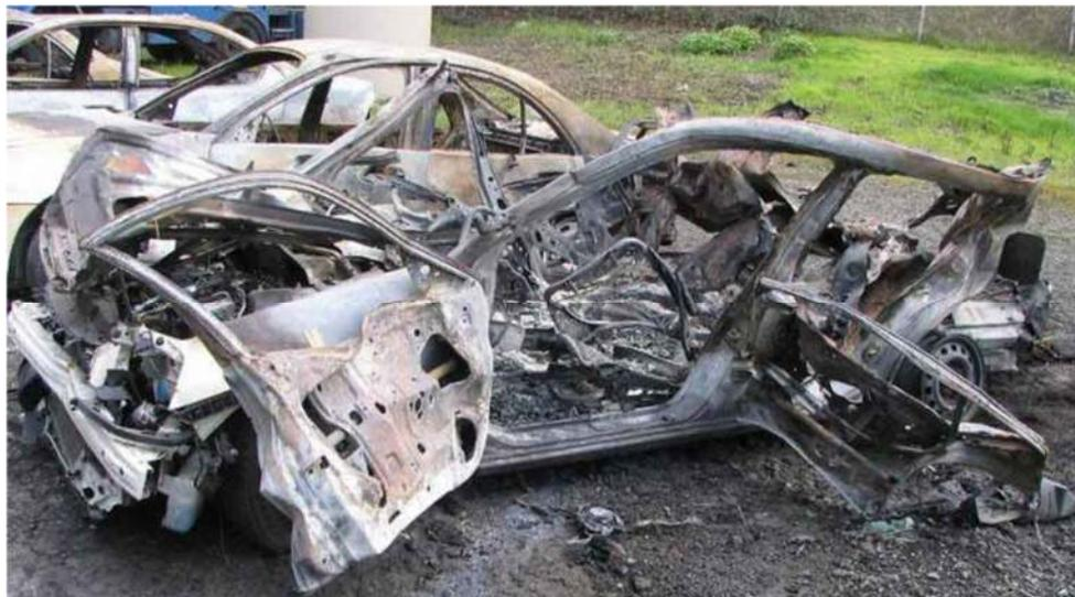
*Ilustración 8-10 Daños por incendio y explosión en un vehículo Honda Civic CNG(gas natural comprimido)después de la ruptura y explosión del tanque. Fuente [37]*
