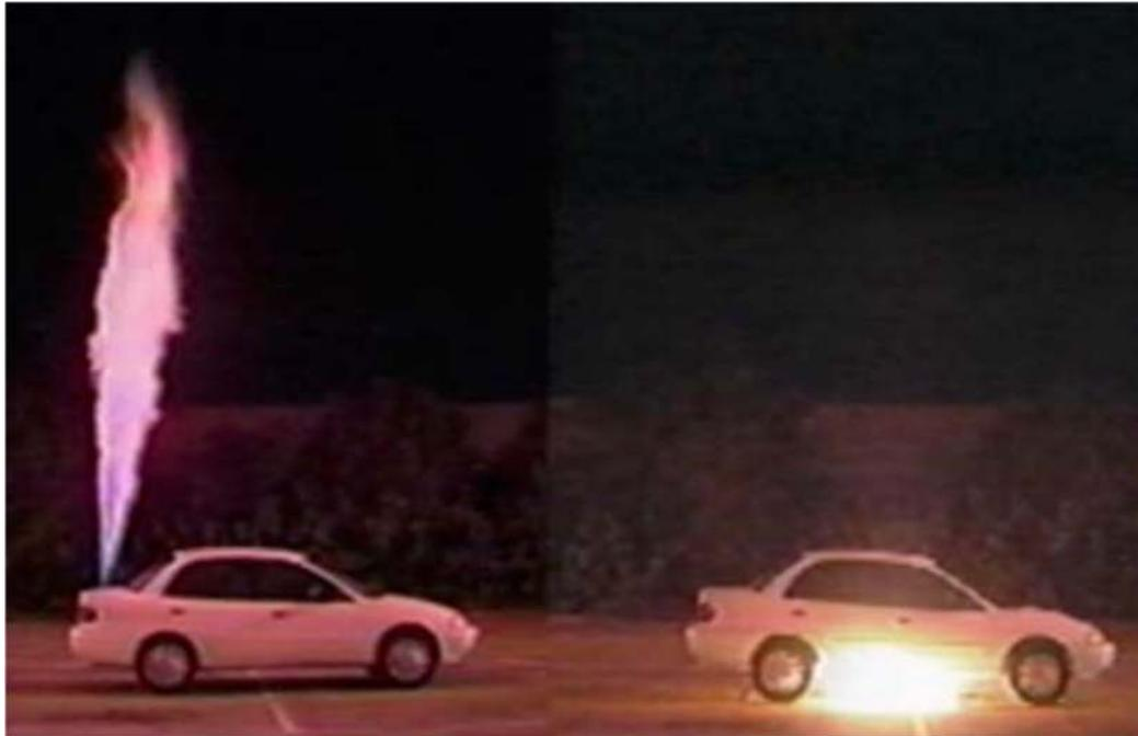
**Ilustración 2-7 . Comparativa entre fuego de hidrógeno (izquierda) y fuego de gasolina (derecha). Fuente [18]**
