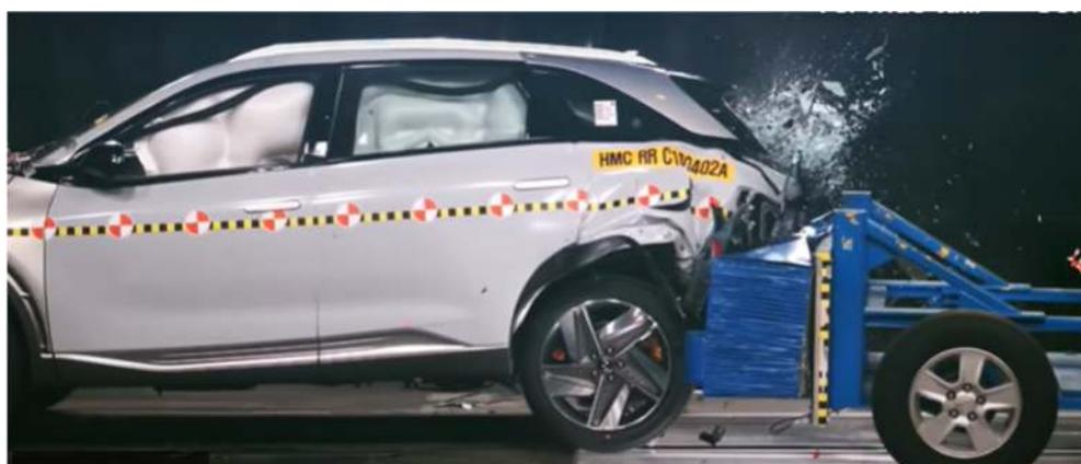
*Ilustración 8-6 Ensayo de colisión trasera por alcance. Fuente [36]*
