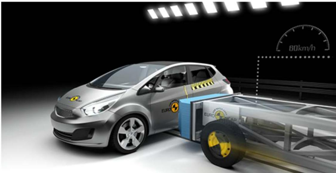
*Ilustración 8-4 Ensayo de colisión lateral con barrera móvil. Fuente [35]*
