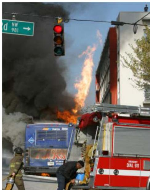
***Ilustración 8-16 Una corriente de gas arde sobre el autobús, probablemente debido a la liberación del DLPT. Fuente [37]***
