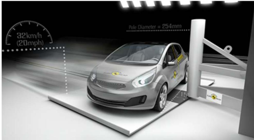
*Ilustración 8-5 Ensayo de colisión lateral con barrera fija. Fuente [35]*
