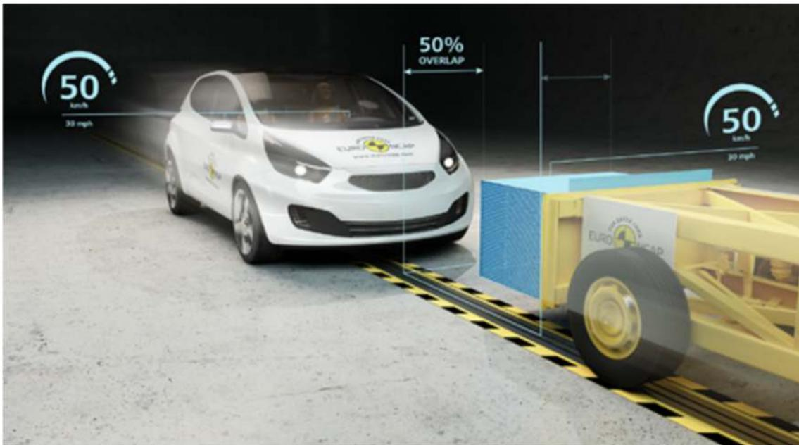
**Ilustración 8-2 Ensayo de colisión frontal con barrera móvil. Fuente [35]**
