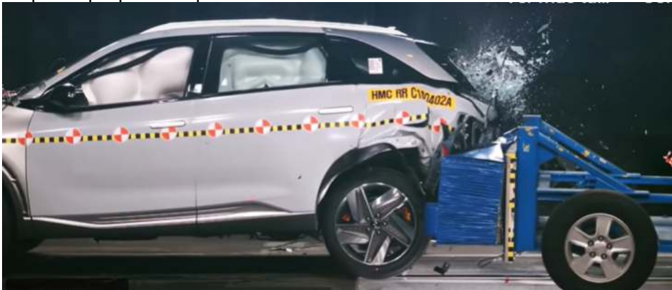
Ilustración 5-1 Ensayo de colisión trasera por alcance. Fuente [12]
