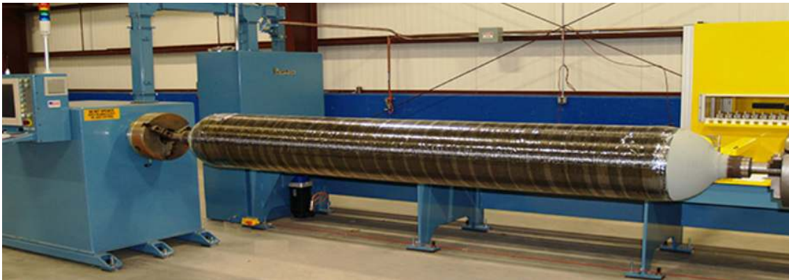
Ilustración 2-4 -Depósitos Tipo II de H 2 comprimido. Fuente [9]
