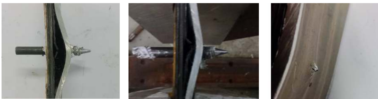
Ilustración 4-4 Detalle de la longitud de punta que perfora las muestras.
