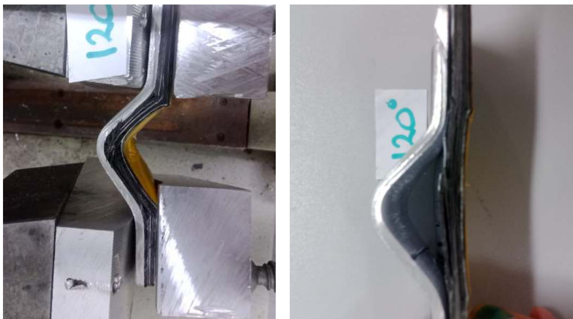
Ilustración 4-8 Detalle del ensayo con punta roma (d= 10 mm).
