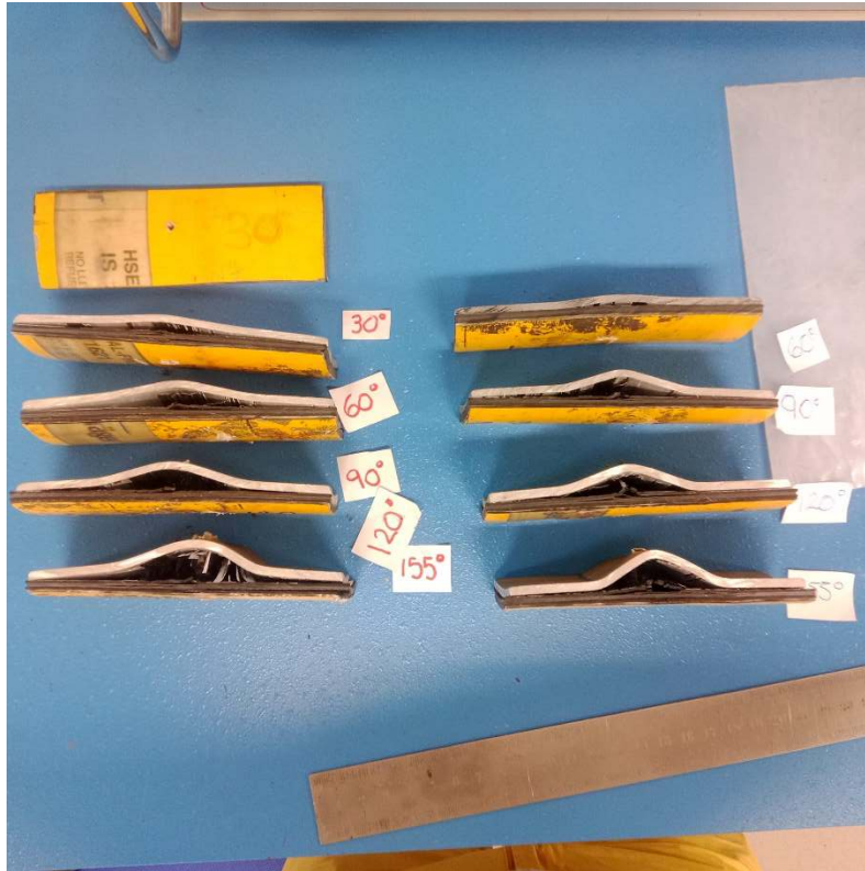
Ilustración 4-7 Comparativa entre muestras. A la izquierda resultados de los ensayos punta cónica, y a la derecha los de punta roma (de d=5\text{mm} ).
