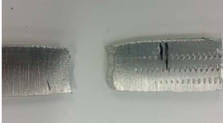
Ilustración 4-10 Detalle de la rotura sufrida por la capa de aluminio.
