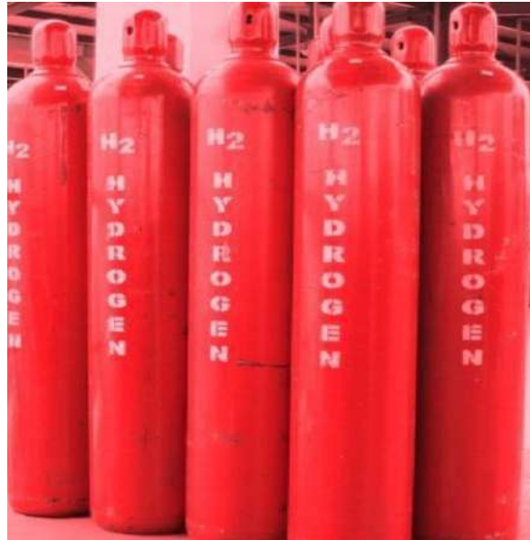
Ilustración 2-3 Depósitos Tipo I de hidrógeno comprimido. Fuente [9]
