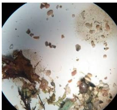
Figura 2.8 Proceso de inspección de MPs (fracción 1-5mm) mediante estereomicroscopio y separación manual.
