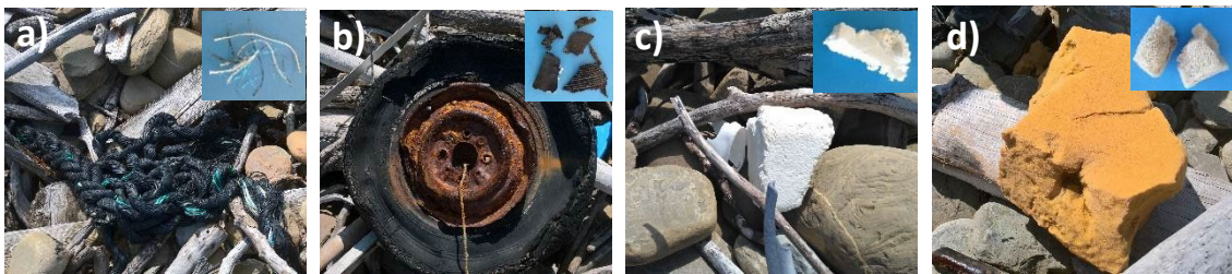
Figura 3.2. Materiales plásticos marinos de origen y muestras ensayadas: cabo de PP (PP LIT ) (a), neumático (NEUM LIT ) (b), fragmento de EPS (EPS LIT ) (c) y fragmento de PU (PU LIT ) (d).
