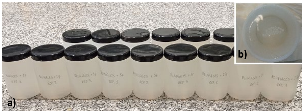
Figura 4.3. Muestras de aguas pluviales con pellets de plástico preparadas para su análisis (a) y detalle de muestra de aguas pluviales con pellets (b).
