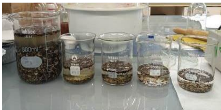
Figura 2.7 Proceso de separación de MPs por flotación en solución salina.
