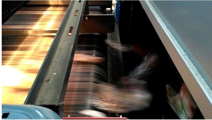
Figura 4.8. Imagen de ensayo de separación óptica de residuos PET de distinto origen en el Test Center de Picvisa.
