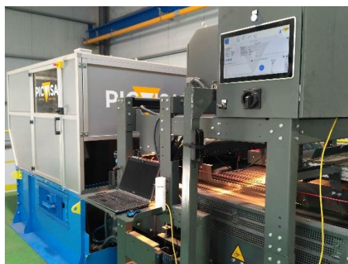
Figura 4.5. Equipo de separación óptica empleado en los ensayos (Picvisa Test Center, Barcelona).
