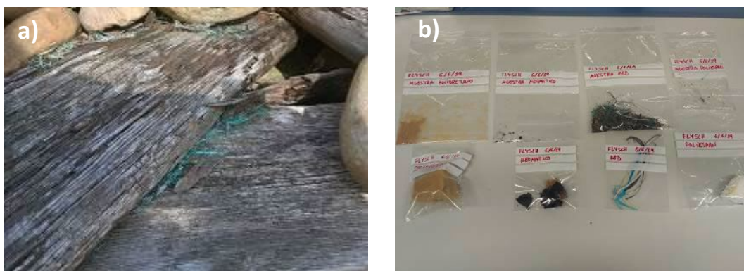
Figura 2.23 MPs desprendidos alrededor de un cabo de amarre de PP (a) y muestras obtenidas en el Geoparque de la Costa Vasca (Zumaia) (b).
