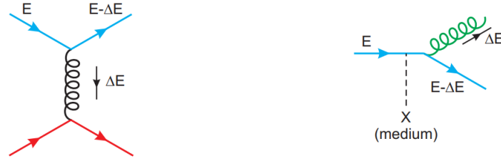
Figura 3.7: A la izquierda, diagrama de la pérdida de energía por colisiones. A la derecha, diagrama de la pérdida de energía por radiación [18].
