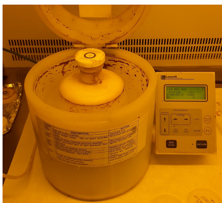
Figura 2.13: El vidrio queda sujeto al soporte del spinner mediante vacío. También recibe un flujo de aire comprimido ( N_2 ) para reducir la humedad. Éstos son esenciales para la inicialización y el desarrollo completo de los programas de centrifugado.
