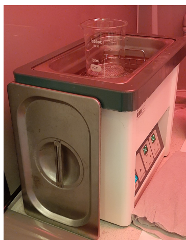
Figura 2.12: El recipiente de acetona con el sustrato en el baño de ultrasonidos.
