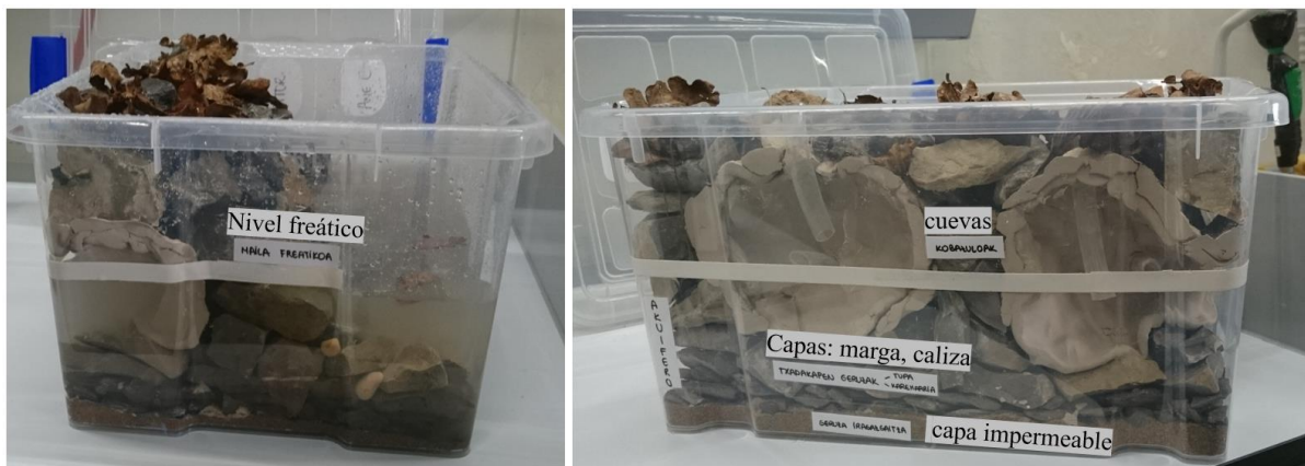
Figura 7.11. Maqueta representando el modelo acuífero elaborada por el grupo D. NC del modelo: CI 3, CII 3, M II 3, P 2. Este grupo representa los componentes y estructura de la sierra y el valle, así como el nivel freático y la capa impermeable inferior. El haber introducido agua de verdad y no haber empleado plásticos u otros materiales impermeables en las cuevas o en el río les permite mostrar el nivel freático y el nivel del río en conexión.
