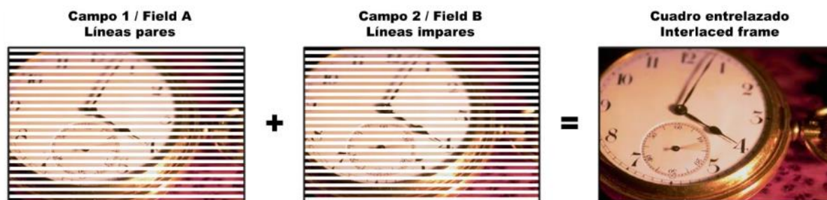
Figura 31. Generación de fotograma en barrido entrelazado
