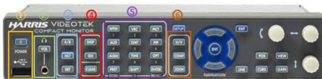
Figura 18. Parte delantera panel auxiliar de control de calidad
