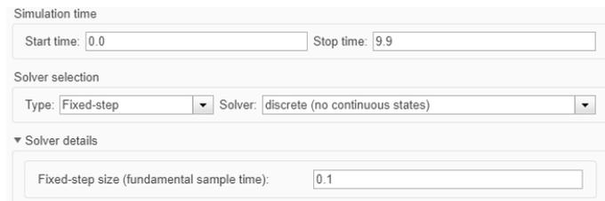
**Figura 44:** Paso 2: Establecer el solver de Simulink a pasos fijos discretos.
