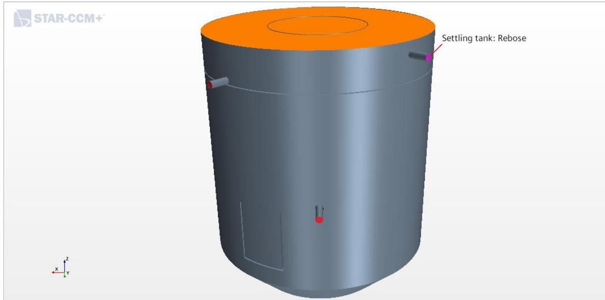
*Ilustración 35: partes principales del decantador: entrada de agua bruta (marcada en rojo), la salida de agua decantada (marcada en granate), la salida de rebose de agua (marcada en fucsia) y la "tapa" del decantador (marcada en naranja)*
