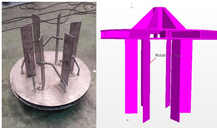
*Ilustración 72: Turbina real (izquierda), modelo 3D generado (derecha)*
