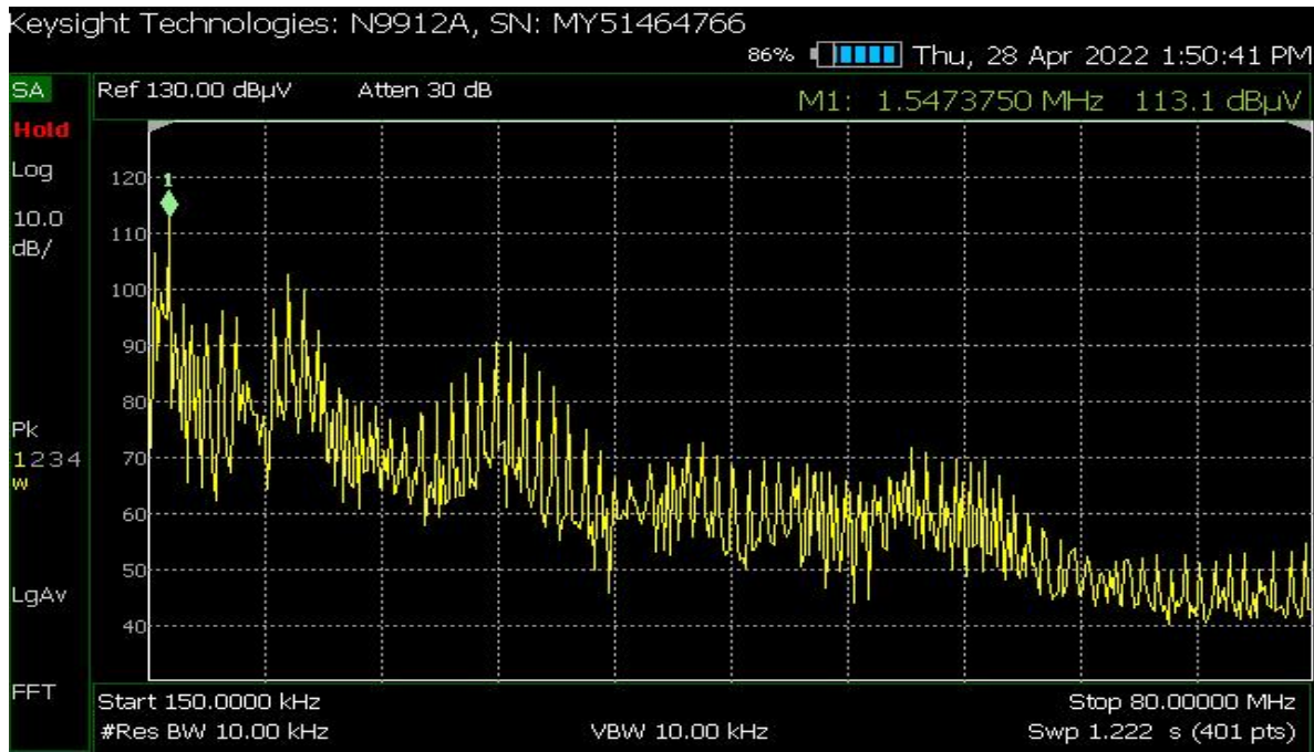
FIGURA 51: BARRIDO DE FRECUENCIAS CON LA TIERRA A VIN-, LISN+, 500 kHz DE CONMUTACIÓN Y 1kW A LA SALIDA.
