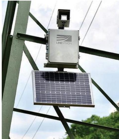
*Figura 3 Ejemplo sistema DLR sin contacto.*
