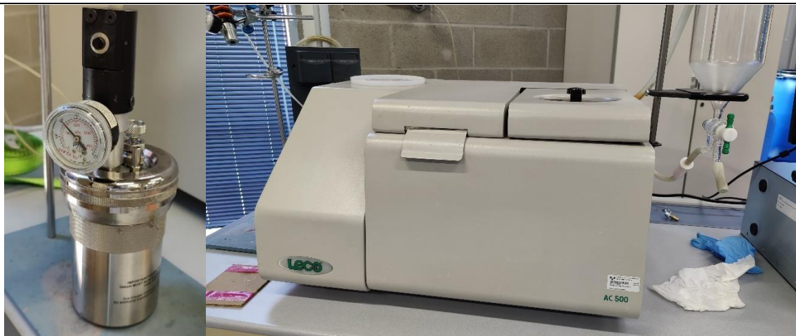
Figura 18 – Análisis de la combustión y del PCS de los residuos líquidos de la activación termofísica mediante una bomba de combustión y un calorímetro automático LECO AC-500.
