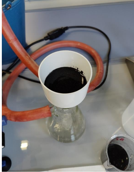
Figura 13 – Limpieza y neutralización del carbón activo.
