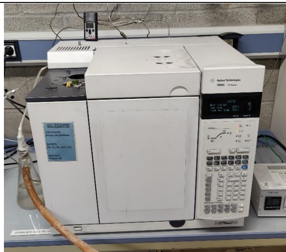
Figura 19 – Cromatógrafo AGILENT 7890 A "GC-TCD/FID" para analizar residuos gaseosos provenientes de la activación termofísica.
