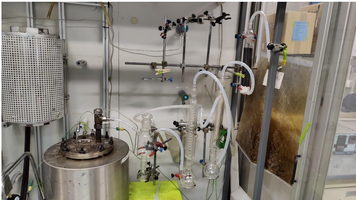
Figura 16 – Imagen real de la planta de pirólisis y activado termofísico.
