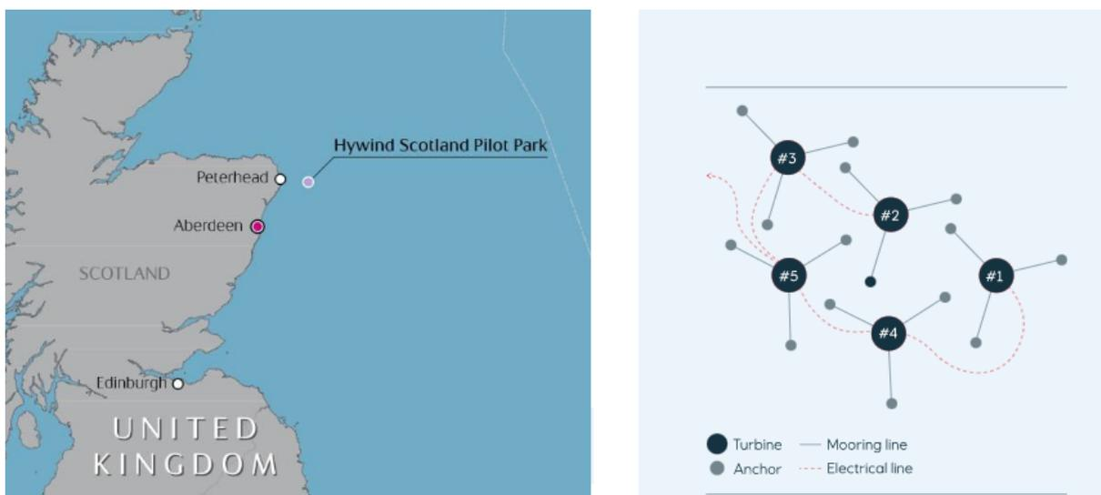
*Imagen 2-5. A la izquierda la localización del emplazamiento. A la derecha, el posicionamiento y la estructura de la instalación[17] [19].*
