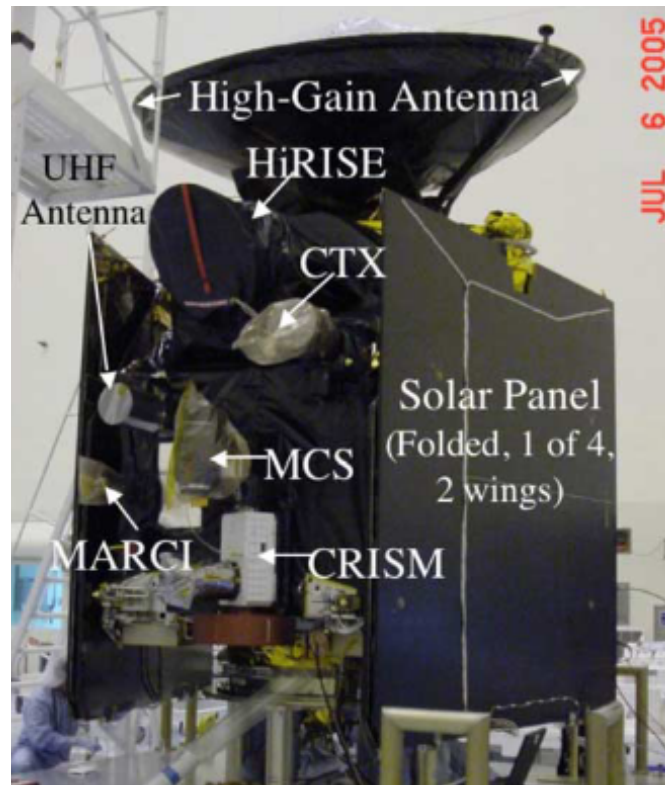
Figura 4: MRO en las instalaciones del Kennedy Space Center antes de integrarlo al lanzador ATLAS V. En la imagen se pueden ver la antena de alta ganancia, los paneles solares y los instrumentos científicos que tiene la nave. [14]
