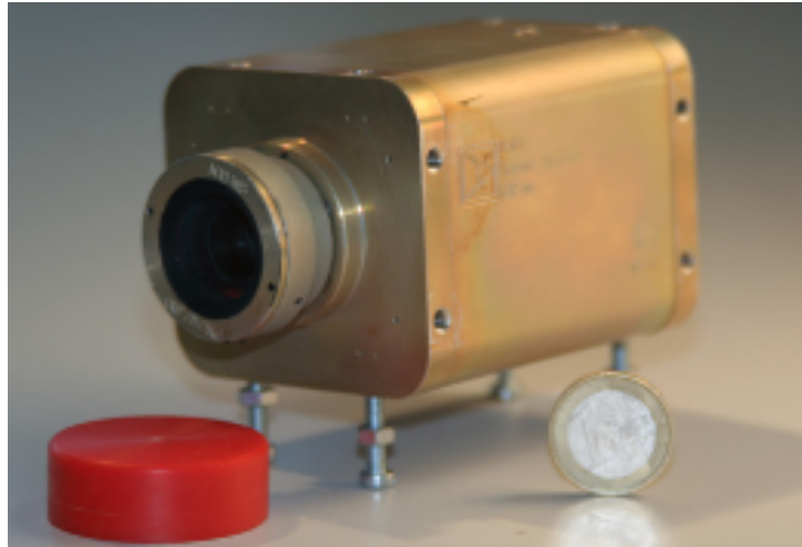
Figura 3: Cámara VMC como la que se envió a Marte en el orbitador MEX con su protector de lente (tapón rojo) y un euro para escala. [12]
