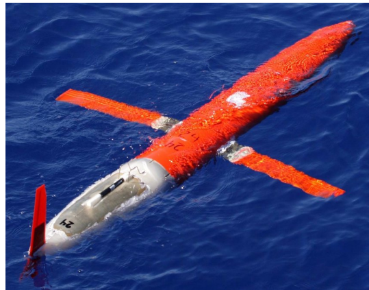
2. irudia: Olatuen maiztasuna eta anplitudea Hawaii-ko kostaldean zehazteko erabilitako glider autonomoa (Woods Hole Oceanographic Institution-ek garatutako urpekaria) [15].
