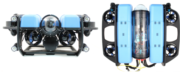
1. irudia: AEBko Blue Robotics enpresaren sei helizeko ROV motako BlueROV2 Heavy drone komertziala [6]. Plataforma irekia da; beraz, dituen elementu mekaniko eta elektronikoak ikasleek garatutako elementuek ordezka ditzakete, integragarritasunerako bateragarritasuna mantenduz.
