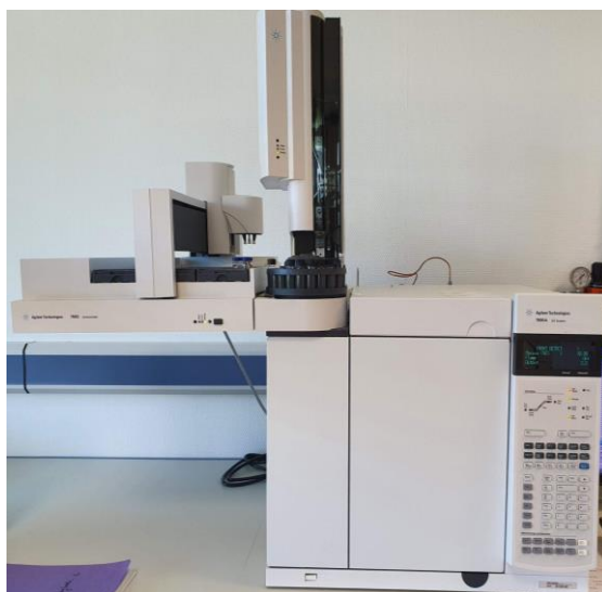
3. Irudia. Agilent 7890A gas-kromatografoa.
