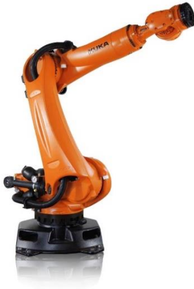
Figura 22. Ejemplo brazo robot articulado real por KUKA Roboter GmbH
