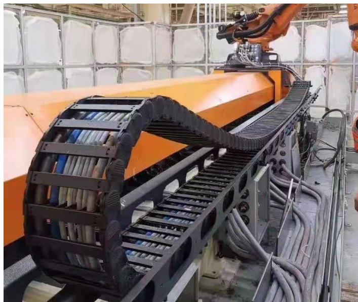
Figura 16. Ejemplo sistema de anti enrollado de cables “cable towline”
