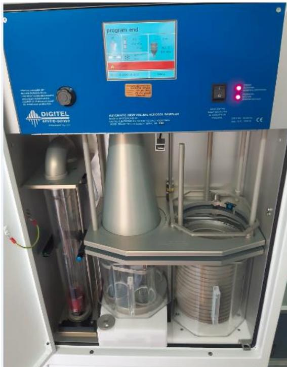
Figura 8. Captador Digitel de la Red de la CAPV
