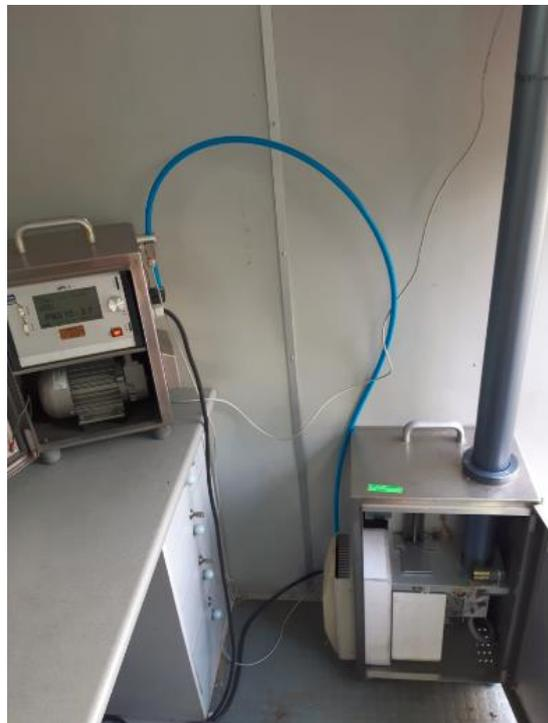
Figura 9. Captador Derenda de la Red de la CAPV
