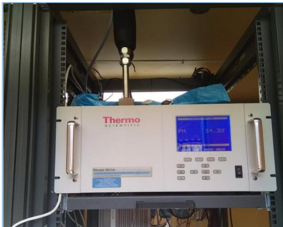
Figura 12. Equipo Thermo 5014 i ubicado en la Estación de Zumarraga
