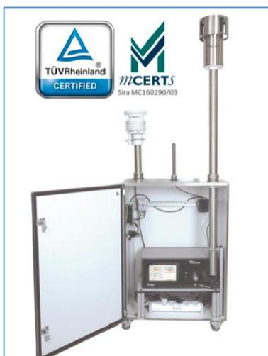
**Figura 14.** Equipo FIDAS con el equipo de intemperie
