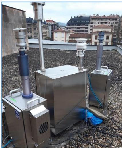
**Figura 27.** Detalle del equipo FIDAS 200 (n/s 12945) y captadores de alto volumen PM10 y PM2,5
