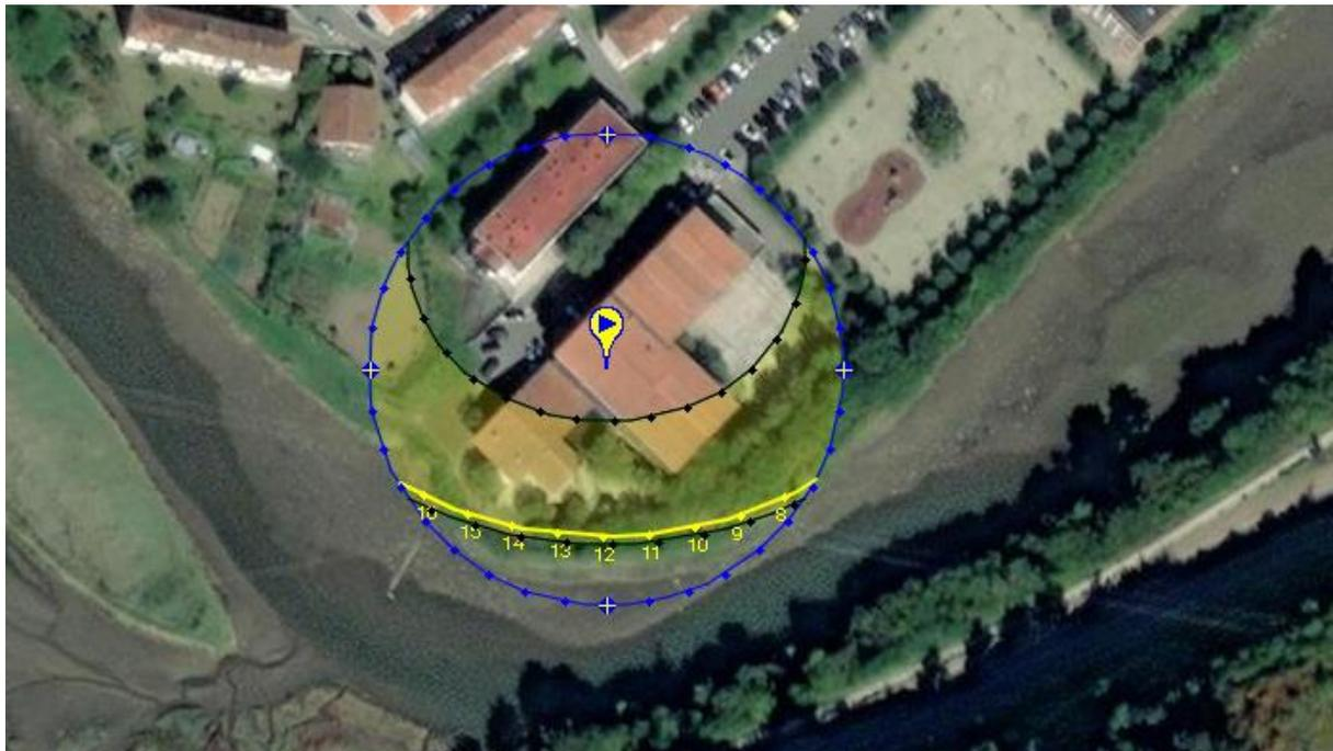
Figura 7. Trayectoria del sol en la ubicación analizada (Fuente: SunEarthTools)
