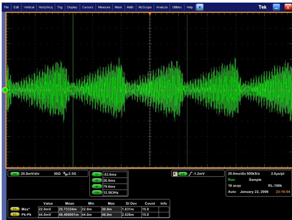
Figura 42: Señal de salida del emulador capturada en el osciloscopio con el fichero con parámetros de una señal de diente de sierra.
