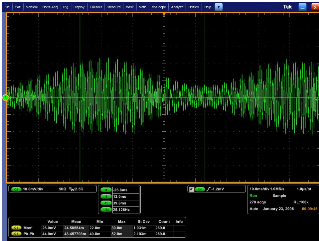
Figura 43: Señal de salida del emulador capturada en el osciloscopio con el fichero con parámetros de una señal sinusoidal.
