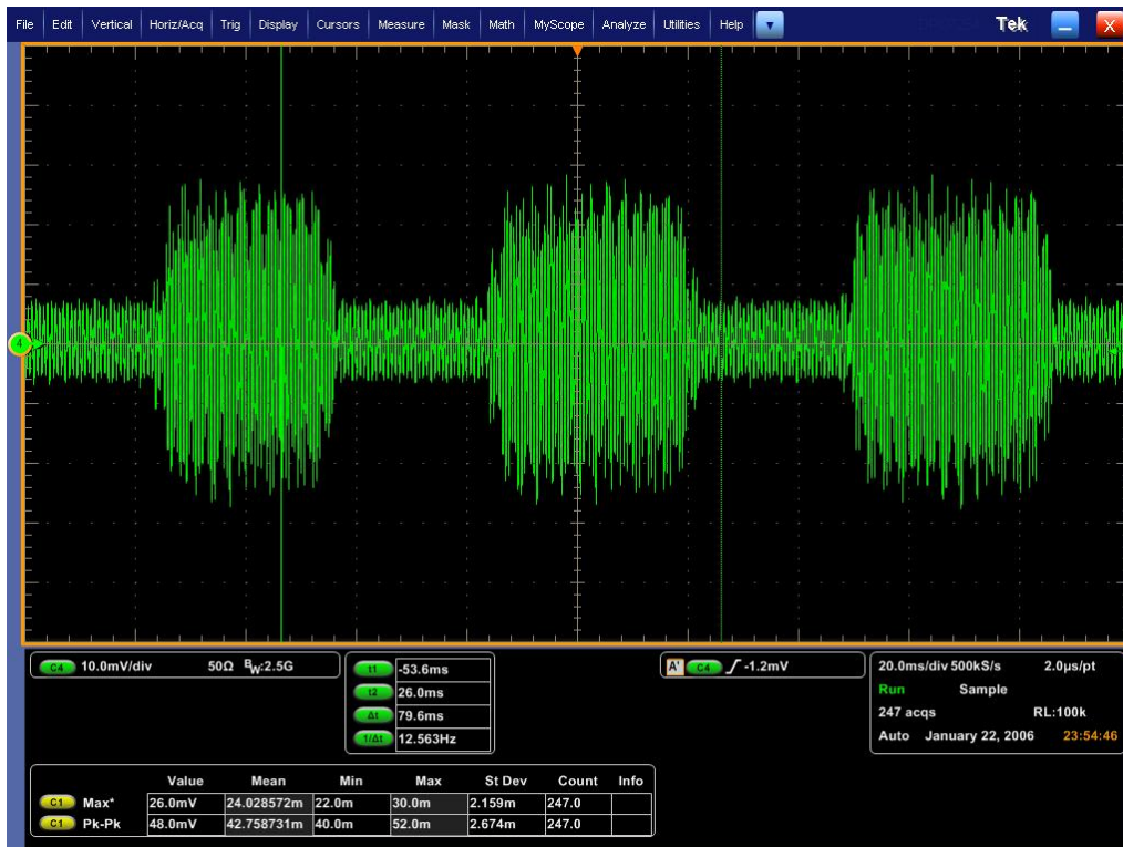
Figura 41: Señal de salida del emulador capturada en el osciloscopio con el fichero con parámetros de una señal cuadrada.
