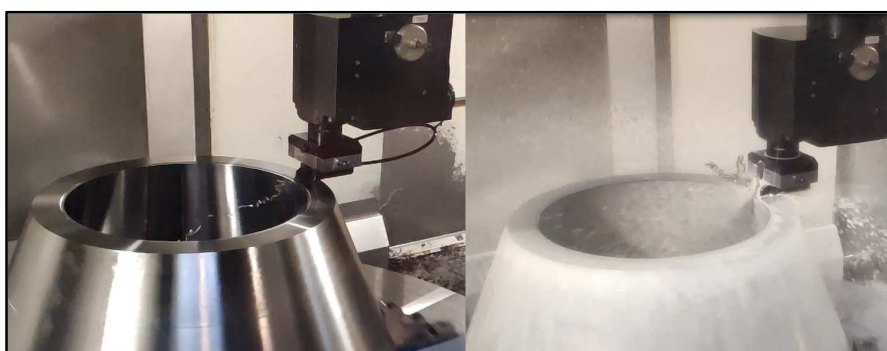
Fig. 2.27. Dinamómetro Kistler en operación de refrentado con herramienta de Prime Turning®.
