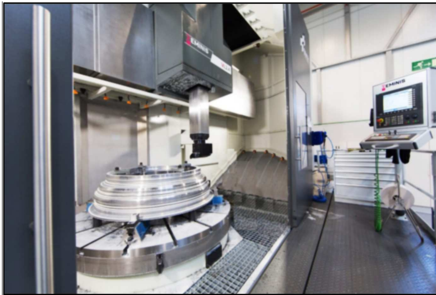
Fig. 2.8. Torneado de pieza aeronáutica en torno vertical GMTK VR-2.4. Centro de Fabricación Avanzada Aeronáutica.
