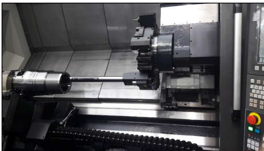
Fig. 2.9. Torneado interior con mandrino antivibratorio. (EMO 2019).
