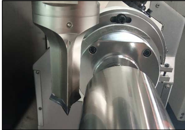
Fig. 2.31. Posicionamiento de la herramienta según el eje Y.
